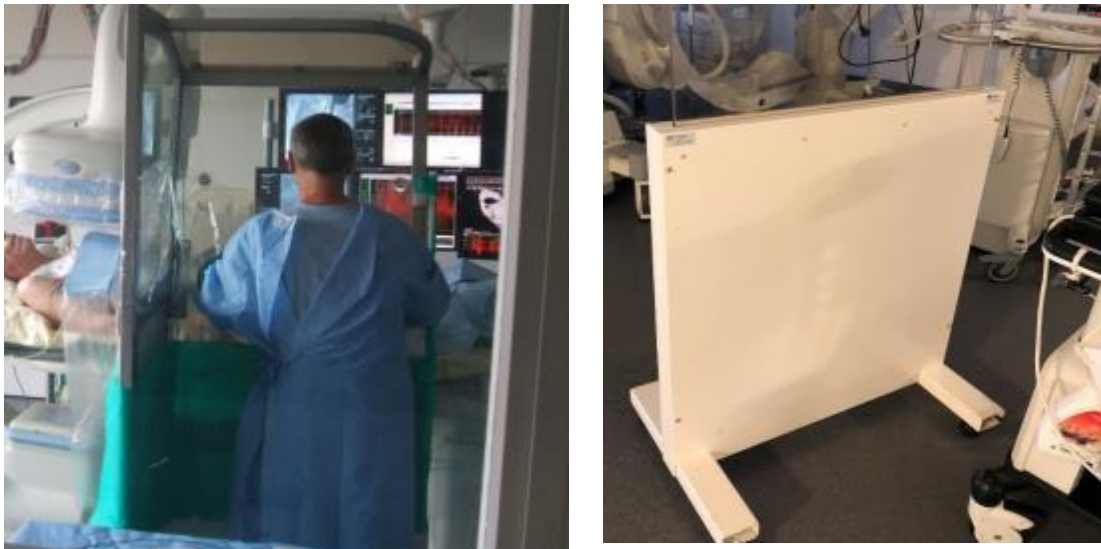
Figure 6 : Paravents mobiles de protection, transparents en partie haute
